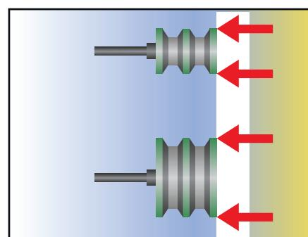
3. Conforme descrito na **identificação**, **verificar** o **perfil** das correias com os canais das polias. Como exemplo, polias com canal "A" devem obrigatoriamente utilizar cor **reia com perfil "A"**, e assim por diante.
